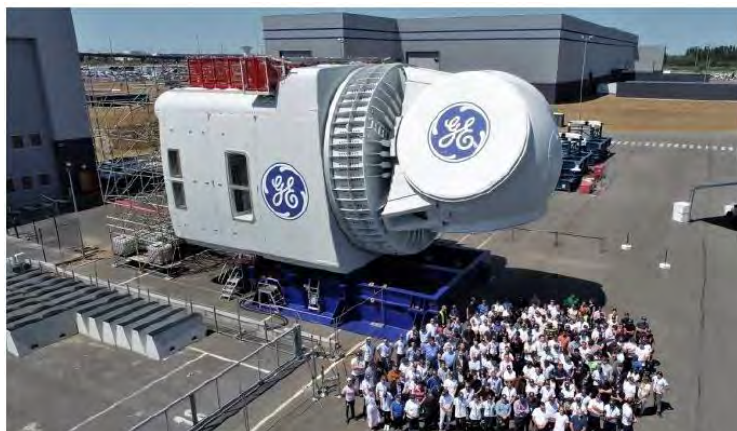
Rys. 5. Grupa stojących pracowników obok ukończonej gondoli dla turbiny Heliade-X o mocy 12 MW produkcji firmy GE Renewable Energy [Nowicki 2019]
