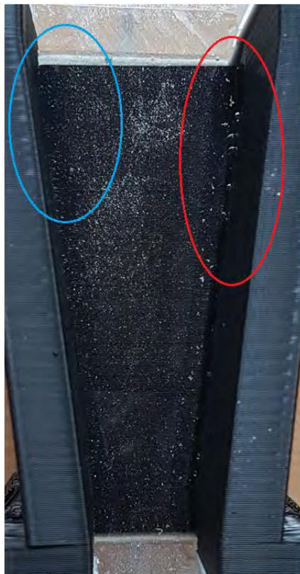
Rys. 4. Zjawisko przepływu wody przez kanał o kształcie opisanym nieciągłą pierwszą pochodną (niebieskim kolorem zaznaczono jedną ze stref powstawania wirów; kolorem czerwonym oznaczono strefę zastoju)
