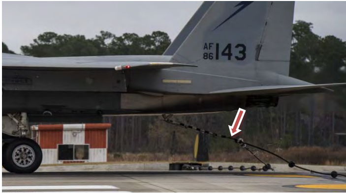
Rys. 1. Hak wychwytyjący samolotu w momencie zaczepienia o linę [Defence24]
