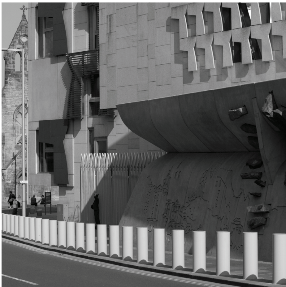
Rys. 2.2. Przykład zabezpieczenia budynku szkockiego parlamentu za pomocą betonowych słupków ograniczających dostęp do niego oraz uniemożliwiających zaparkowanie pojazdu (źródło: http://www.flickr.com/photos/itmpa/4858061246/sizes/o/in/photostream )
