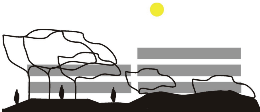
Rys. 2.15. Niewykorzystane w formie budynku zróżnicowane ukształtowanie terenu zwiększające bezpieczeństwo podczas ataku terrorystycznego (rys. A. Nadolny)
