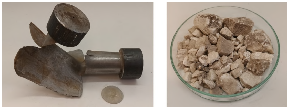
Rys. 112. Rezultat testu przejścia palenia w detonację
