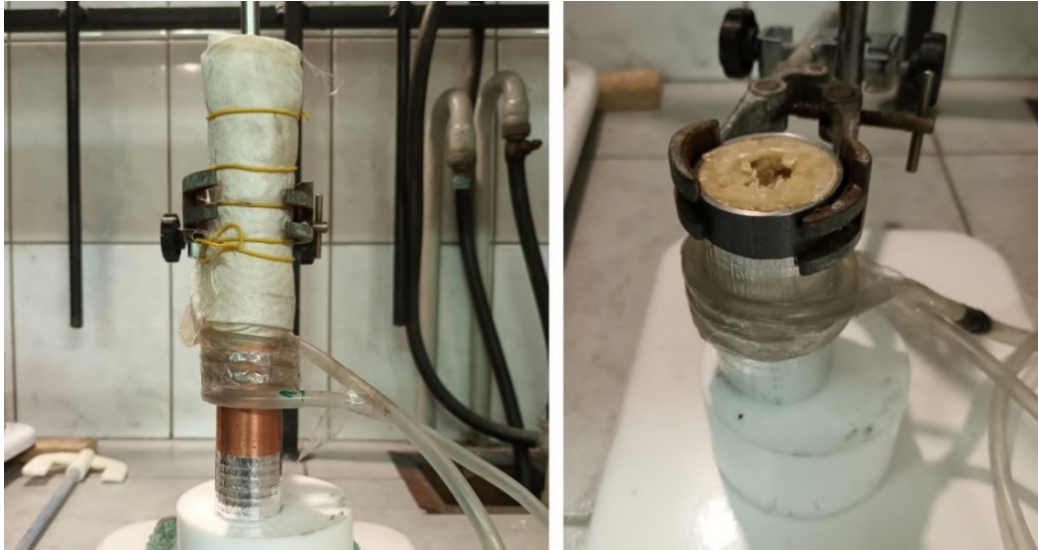
Rys. 99. Chłodzenie strefowe odlanych ładunków
