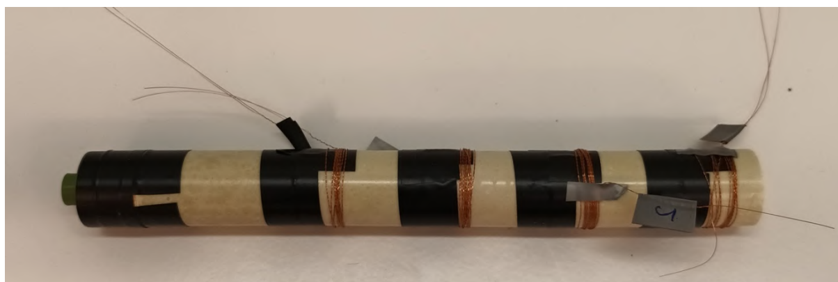
Rys. 108. Zdjęcie ładunku kompozycji PRX-1M przygotowanego do badania prędkości detonacji
