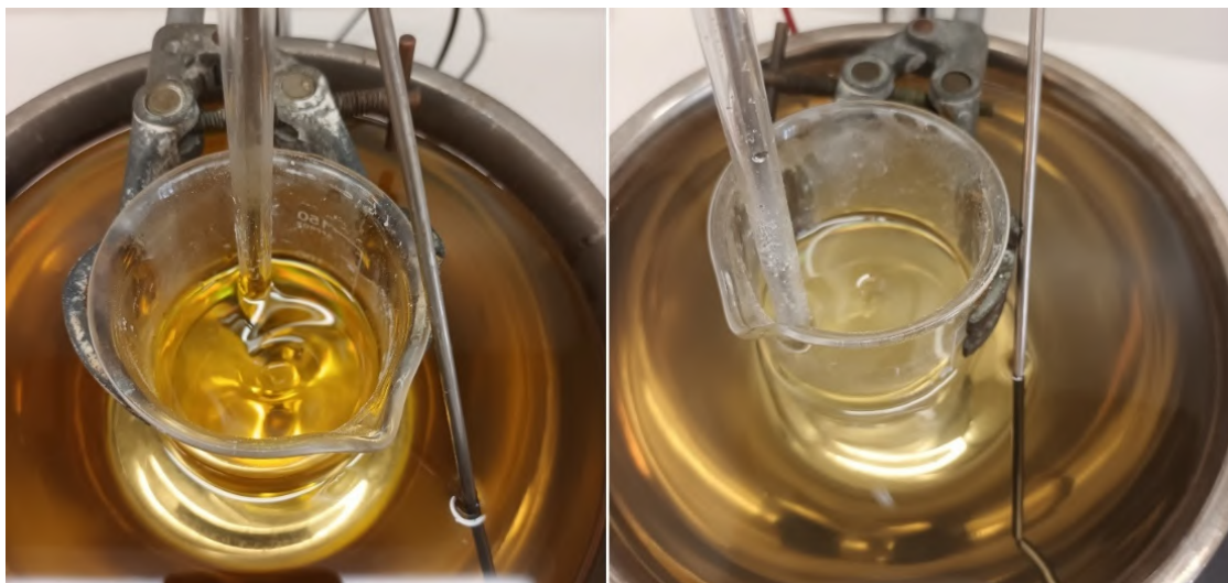
Rys. 86. Przebieg badania rozpuszczalności. Po lewej widoczny klarowny roztwór MW w PrNQ, po prawej moment osiągnięcia pełnego nasycenia roztworu.
