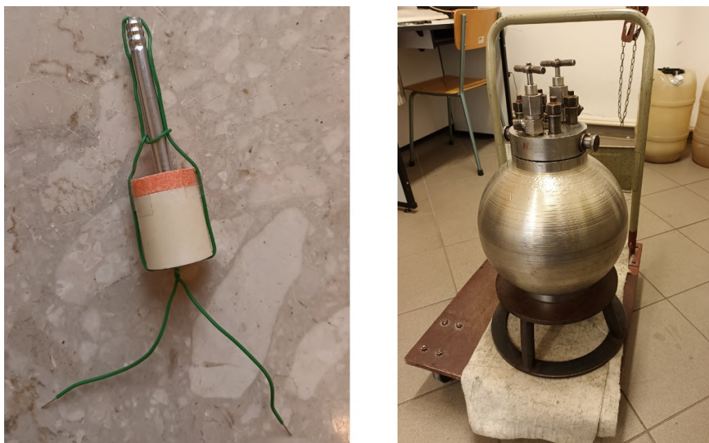
Rys. 113. Ładunek z zamocowanym pobudzaczem i zapalnikiem, oraz bomba kalorymetryczna do pomiarów ciepła wybuchu
