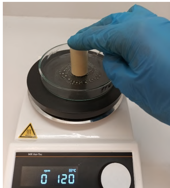
Rys. 101. Wyrównywanie powierzchni przełomu ładunku przez nadtapianie
