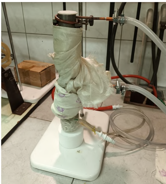
Rys. 102. Po lewej: układ do chłodzenia strefowego ładunku z jednoczesnym dogrzewaniem odcinka nadlewkowego. Po prawej: gotowy ładunek ( \phi 32 mm) wyjęty z formy.
