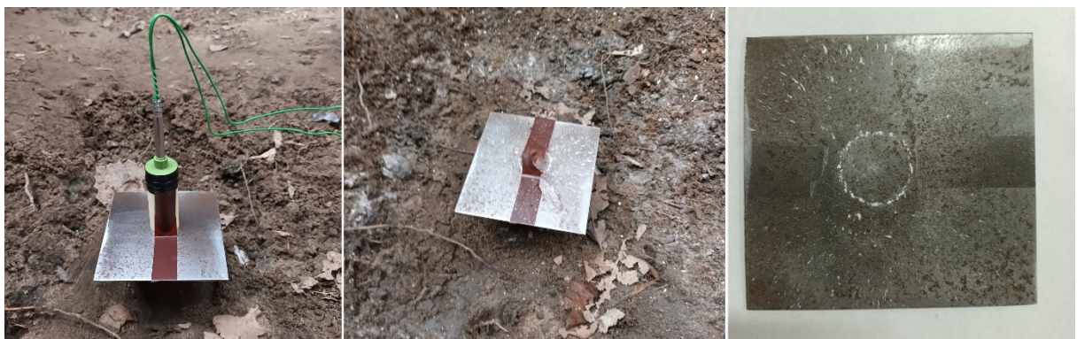
Rys. 104. Rezultaty badania zdolności do detonacji odlewanych ładunków kompozycji PRX-1M przy pobudzeniu wyłącznie zapalnikiem
