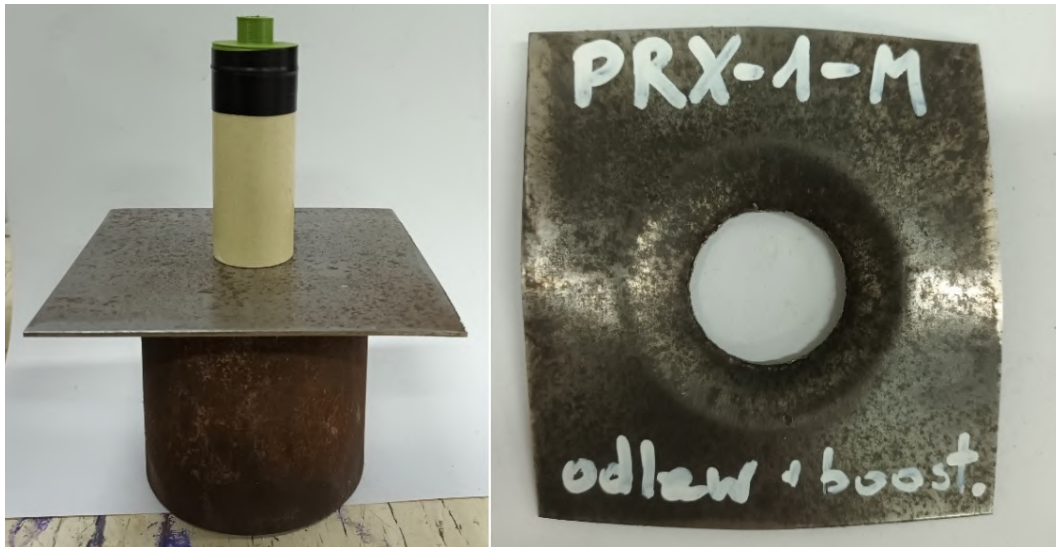
Rys. 105. Rezultat próby zdolności do detonacji odlanego ładunku PRX-1M z dodatkowym pobudzaczem heksogenowym
