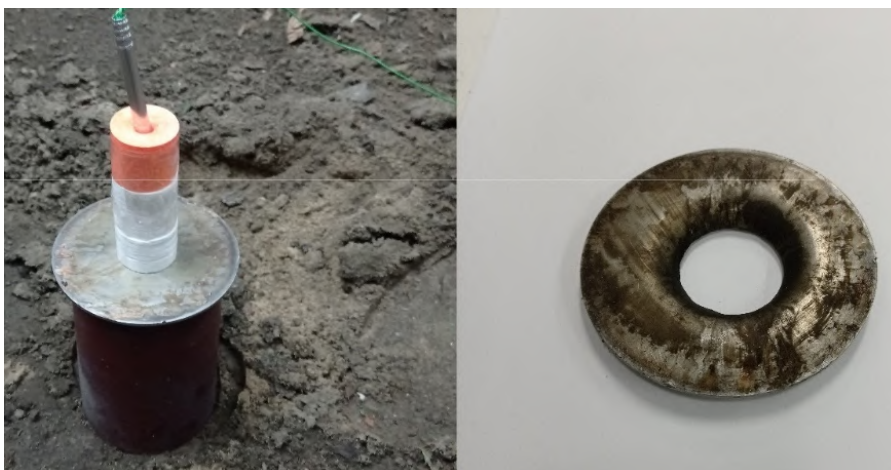
Rys. 85. Rezultat badania zdolności do detonacji prasowanej HMNQ
