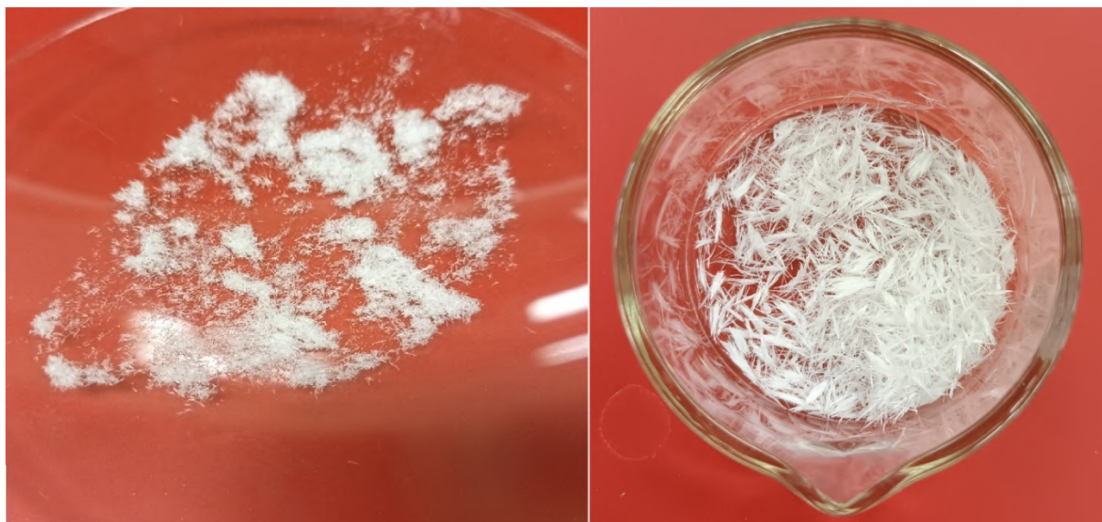
Rys 46. Drobnokrystaliczny przesiew, oraz odsiane zbrylenia i grubokrystaliczna NQ, które należy oddzielić przed reakcją
