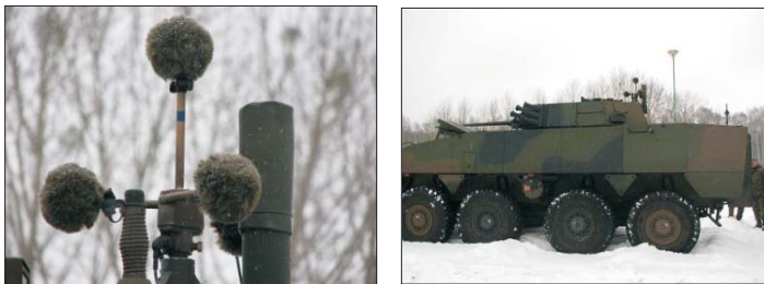
Rys. 2. Widok zespołu mikrofonów ASA systemu PILAR firmy 01dB-Mettravib (po lewej) oraz sposób ich zamontowania na KTO Rosomak (po prawej)
