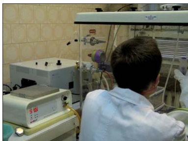
Rys. 1. Rozpylanie bioaerozolu (z lewej w głębi przyrząd UVAPS)
