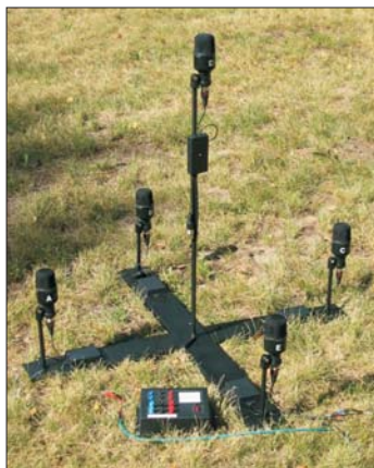
Rys. 14. Zestaw mikrofonów czujnika akustycznego w stojaku umożliwiającym ich prawidłowe rozmieszczenie
