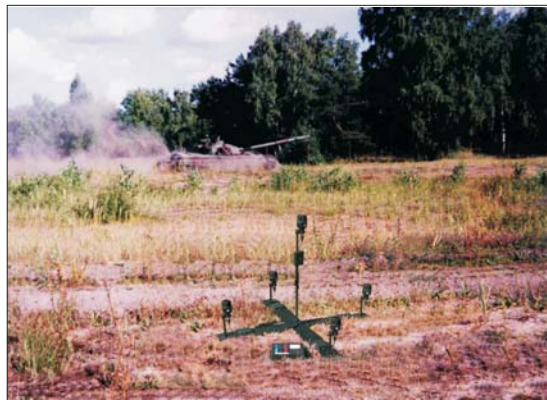
Rys. 17. Widok sytuacji pomiarowej podczas testowania czujnika akustycznego za pomocą sygnału akustycznego generowanego przez czołg PT91
